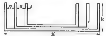
Rys. 1. Schemat radiatora dla tranzystora T3
